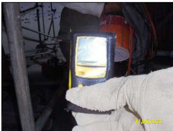
ค) การตรวจวัดประเมินสภาพอากาศในพื้นที่อับอากาศ
