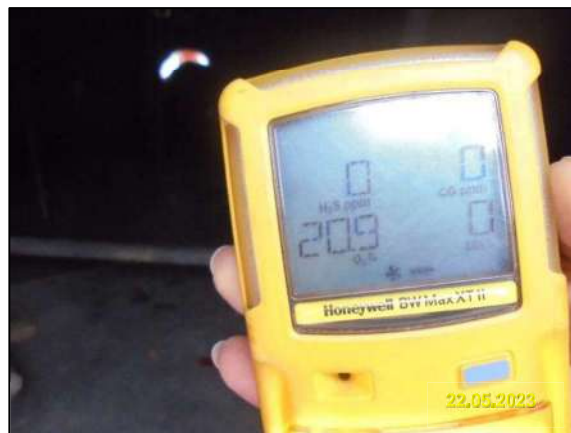
ค) การตรวจวัดประเมินสภาพอากาศในพื้นที่อับอากาศ
